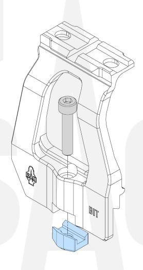
□ clamping bar □ M5 bolt
