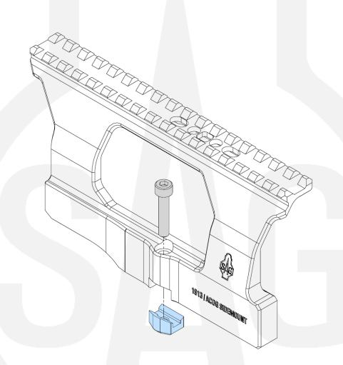
□ clamping bar □ M5 bolt
